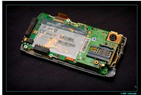
Jetzt schauen wir uns das Detail mit dem Schalter (wir erinnern uns: der für Ton an/aus) noch mal genau an, so daß der Schalter an der Platine und das Kunststoffteil im Gehäuse wieder zusammenpassen. Wer das nicht richtig macht, kann den Schalter später nicht mehr bewegen und muß alles noch mal auseinanderbauen.
