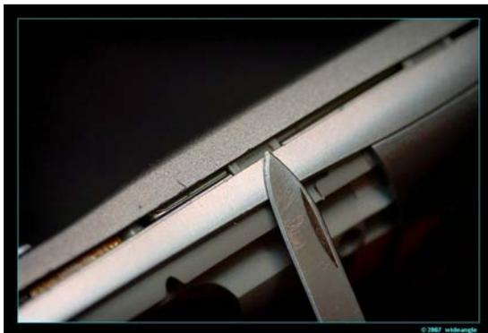
Auf dem Bild links sieht man, wo die Clips sind, diese sind dabei zu öffnen. Man kann statt die Fingernägel zu benutzen die Clips auch mit dem Taschenmesser oder dem Schlitz-Schraubendreher aufhebeln, die Gefahr, dabei das Gehäuse zu beschädigen, ist jedoch groß. Wer einen speziellen Gehäuseöffner hat, kann den natürlich verwenden, damit geht es am einfachsten.
