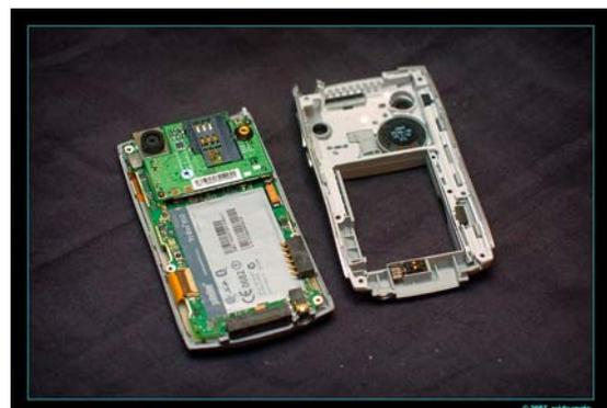
Wenn das Gehäuse geöffnet ist, können wir den Deckel abnehmen. Darunter verbirgt sich die Kamera, die mit einem Kunststoffring gegen Streulicht abgeschirmt ist. Dieser Kunststoffring ist nur lose aufgelegt, also ab damit in die Tupperdose...
