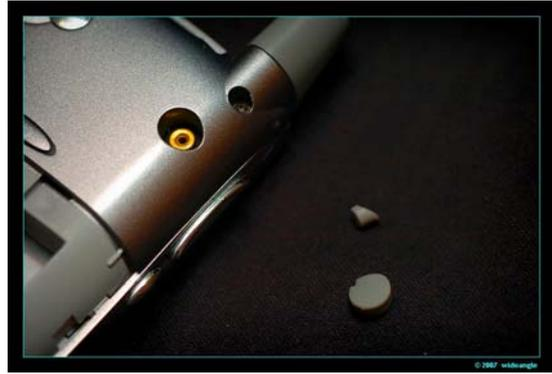
Jetzt ist auch die 7. Schraube zugänglich. Diese Schraube ist für die Antenne und ein Stück länger als die anderen. Das ist wichtig später beim Zusammenbau, man darf die Schrauben dort nicht vertauschen – die lange Schraube für die Antenne würde, schraubt man sie an der falschen Stelle ein, das Gehäuse beschädigen!
